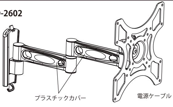
テレビの電源ケーブルをアームの内側に整備することが出来ます。上の図のようにアームにはまっているプラスチックカバーを外してから、コードを通し、再びカバーをはめて下さい。
