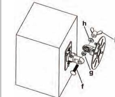
左図に従って、スピーカーブラケットとスピーカーを組み立てます。
