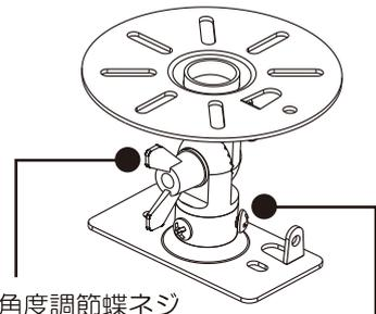
図・写真のように落下防止ワイヤーと抜け防止ピンを取り付けます。抜け防止のピンは回っておりません。取り付け・取り外しの際は怪我にご注意ください。抜け防止ピンのデザインや大きさは写真と異なる場合がございます。
