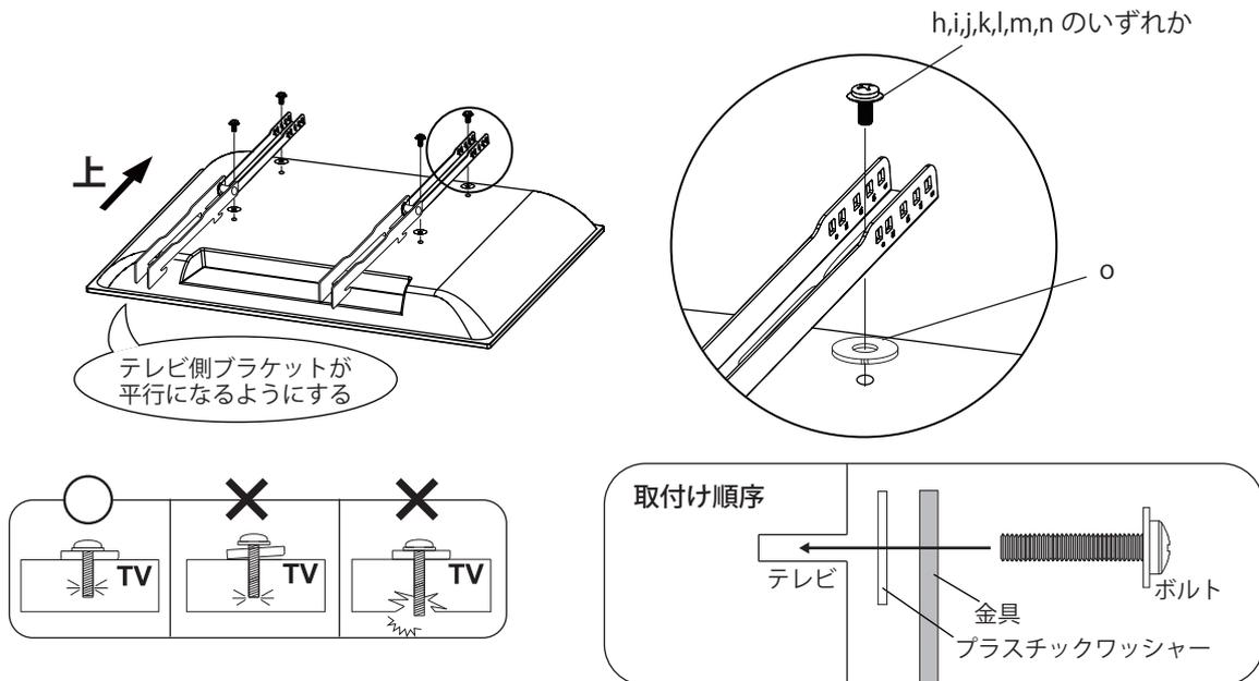
テレビを固定したら、テレビ側ブラケットを角度調節用の部品 (c,d,e,f,g) を使い固定します。この時、角度調節をしたい場合は、右下図を参照に、c (出っ張りが無い方がテレビ側) を固定したい穴に合わせながら d,e,f,g を固定します。角度調節しない場合は左下図を参照に d,f,g を使い固定します。g を固定の際は、六角レンチソケット等の工具があると便利です。
