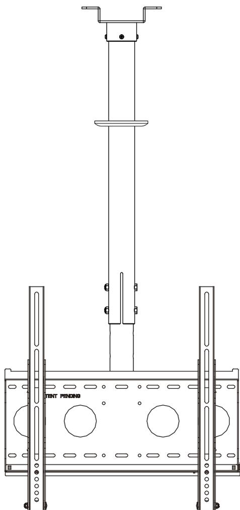
※付属の天井用ボルトはコンクリート用です。コンクリートの天井以外へのお取付けは、取付ける天井の種類に合わせて適切なネジを別途ご用意ください。
