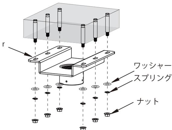
注意：天井プレート (r) を天井板に取付ける時は天井用ボルト (s) の配列順序に注意してください。
